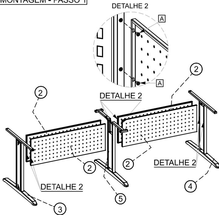
INICIE MONTANDO A ESTRUTURA: FIXE O PÉ LATERAL ESQUERDO (3), O PAINEL CENTRAL (2) E O PÉ CENTRAL (5) COM OS PARAFUSOS (A) EM SEGUIDA FIXE O PAINEL CENTRAL (2) E O PÉ LATERAL DIREITO (4) CONFORME O DETALHE 2.
