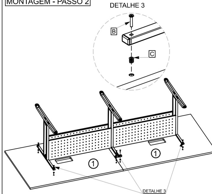
NA SEQUENCIA PARA FACILITAR A FIXAÇÃO DO TAMPO (1) NA ESTRUTURA, POSICIONE O TAMPO (1) NO CHÃO E FAÇA A FIXAÇÃO TOTAL DOS PÉS LATERAIS COM OS PARAFUSOS (B).
